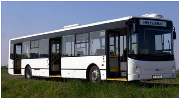
Magyar gyártmányú hidrogén üzemű busz prototípusa, amelyet a H2 Bus Kft. gyárt
